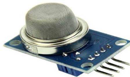
Fig: 2 Mq-2 Sensor
