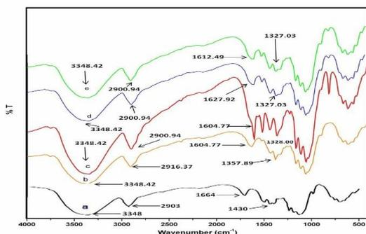
Fig 1: FT-IR Spectrum of (a) Cellulose (Cell), (b) Cell-TA (c) Cell-TA-Cu (d) Cell TA-Ni (e) Cell TA-Pb.
